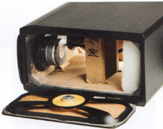
Membrana bierna to nic innego jak płyta pilśniowa z dodatkowym ciężarkiem na spiderze.
