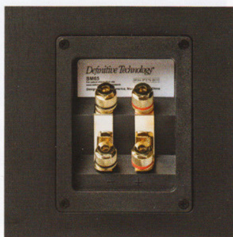
Terminale są podwójne, standardowe. Zwory lepiej zdjąć, zastępując je krótkimi przewodami lub zastosować bi-wiring.
